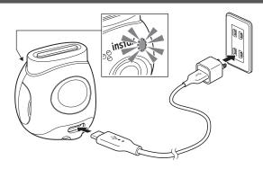
Ligue a câmara com o cabo de carregamento dedicado fornecido a um adaptador USB CA (vendido separadamente) e, em seguida, ligue o adaptador USB CA a uma tomada interior.
