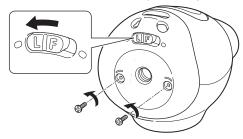
**2** Pressione e segure ambas as extremidades da câmara para libertar e remover a tampa.
